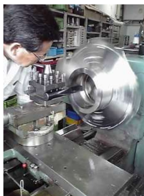
旋盤加工 Maxφ1400mm
