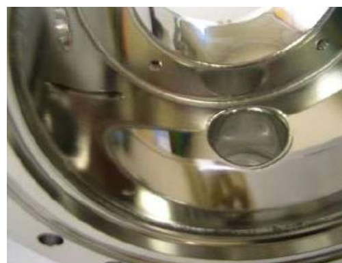
内面 # 400研磨+電解研磨仕上げ
