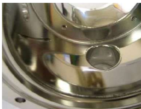
内面 # 400研磨+電解研磨 仕上げ
