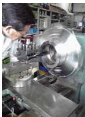
旋盤加工 Maxφ750mm
