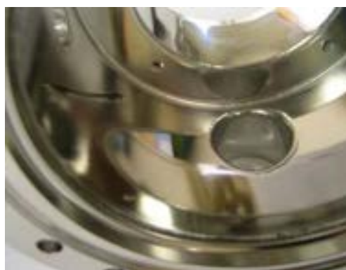
内面 # 400研磨+電解研磨 仕上げ
