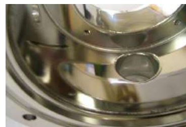
内面#400研磨+ 電解研磨仕上げ
