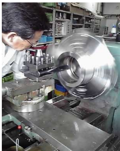
旋盤加工 Maxφ750mm
