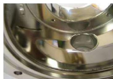
内面#400研磨＋ 電解研磨仕上げ
