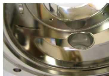
内面#400研磨＋ 電解研磨仕上げ
