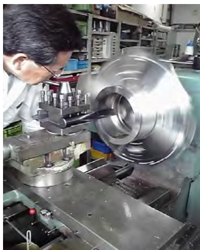
旋盤加工 Maxφ750mm
