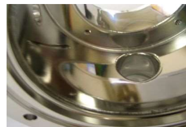
内面#400研磨＋ 電解研磨仕上げ
